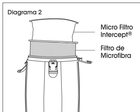
2. Remplácelo en caso de ser necesario. Un filtro atascado y sucio restringe el flujo de aire, reduciendo la succión y propiciando el sobrecalentamiento.
