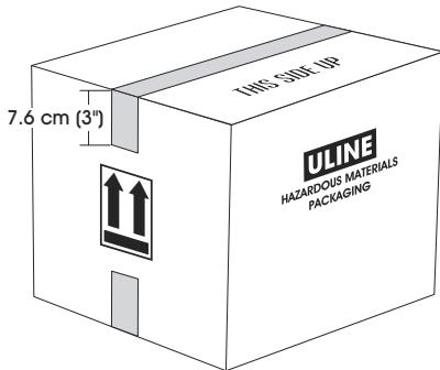
8. Selle la parte superior de la caja de cartón por la abertura central con una tira de cinta de polipropileno de 5 cm (2") de ancho (2 mil) (Uline Modelo # S-472). La cinta debe extenderse 7.6 cm (3") por cada uno de los extremos de la caja de cartón. (Vea Diagrama 6)
