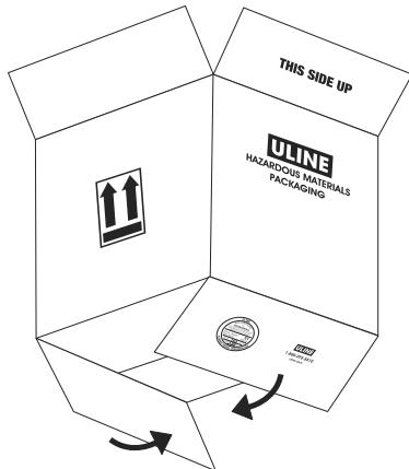
1. Doble las solapas de la parte inferior de la caja de cartón de forma que coincidan. La certificación del fabricante debe quedar a la vista en la parte exterior de la caja. (Vea Diagrama 1)
