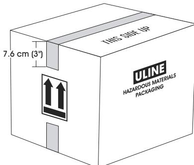
9. Selle la parte superior de la caja de cartón por la abertura central con una tira de cinta de polipropileno de 5 cm (2") de ancho (2 mil) (Uline Modelo # S-472). La cinta debe extenderse 7.6 cm (3") por cada uno de los extremos de la caja de cartón. (Vea Diagrama 6)
