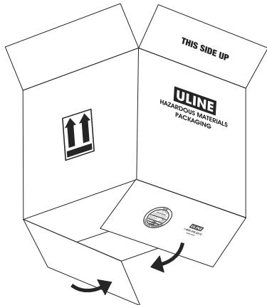
1. Doble las solapas de la parte inferior de la caja de cartón de forma que la certificación del fabricante quede a la vista en la parte exterior de la caja. El espacio entre las solapas exteriores no podrá ser superior a 0.3175 cm (0.125"). (Vea Diagrama 1)
