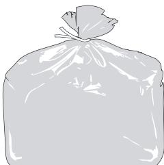
3. Coloque la bolsa de aire dentro de la bolsa de polietileno antiestática de 2 mil que se incluye. La bolsa de polietileno deberá sellarse con el cincho de 14 cm (5.5") 40# que se incluye. (Vea Diagrama 3)
