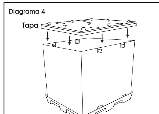
5. Para fijarla, deslice los 4 clips de la tapa para colocarlos en la posición de bloqueo. (Vea Diagrama 5)
