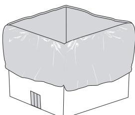
5. Vierta una capa uniforme de un mínimo de 8.15 cm (3.21") de Vermiculita Grado 4 en el fondo de la bolsa de polietileno.
