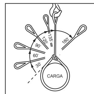
**Efecto de la Clavija del Grillete de Anclaje o Gancho de Grúa en el Ojo de la Eslinga**
