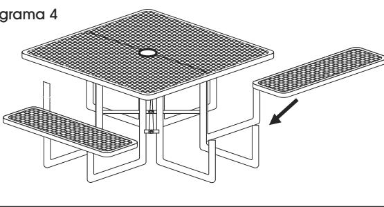
4. Voltee la mesa en posición vertical. Fije los asientos a las patas utilizando un perno, dos rondanas y una tuerca. (Vea Diagrama 4)
