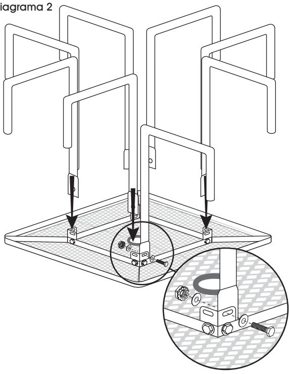
2. Fije las patas a la pestaña de extensión utilizando un perno, dos rondanas y una tuerca. Repita la operación con las tres pestañas de extensión restantes. (Vea Diagrama 2)
