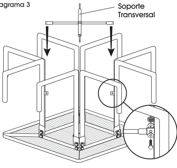
3. Alinee el orificio del soporte transversal entre los orificios de las patas de la mesa y fije utilizando un perno, 2 rondanas y una tuerca. Repita la operación con los tres orificios restantes del soporte transversal. (Vea Diagrama 3)
