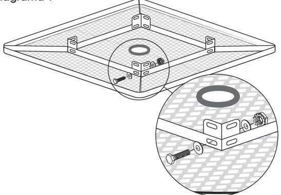
1. Voltee la cubierta de manera que la parte inferior quede hacia arriba. Fije la pestaña de extensión a la cubierta cuadrada utilizando un perno, dos rondanas y una tuerca. Repita la operación con las tres pestañas de extensión restantes. (Vea Diagrama 1)
