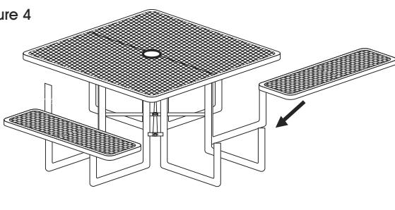
4. Retournez la table à l'endroit. Fixez les sièges aux pieds avec un boulon, deux rondelles et un écrou. (Voir Figure 4)
