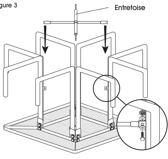
3. Alignez le trou de l'entretoise entre les trous des pieds de la table et fixez-la avec un boulon, deux rondelles et un écrou. Répétez l'opération pour les trois autres trous de l'entretoise. (Voir Figure 3)
