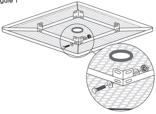
1. Retournez la surface de table de sorte que la face inférieure soit orientée vers le haut. Fixez une attache d'extension à la surface carrée avec un boulon, deux rondelles et un écrou. Répétez l'opération pour les trois autres attaches d'extension. (Voir Figure 1)
