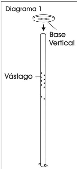
3. Alimente el soporte para rollo sobre el vástago con el lado achaflanado hacia abajo.
