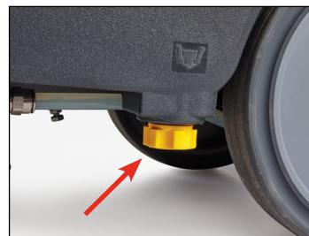
5. Limpie el filtro de desagüe de detergente desenroscando la tapa del filtro del tanque y quitando el conjunto del filtro. Limpie a fondo y vuelva a asegurarla en su lugar.
