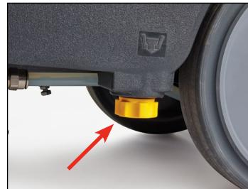
5. Nettoyez le filtre du drain de détergent en dévissant son capuchon et en retirant l'ensemble du filtre. Nettoyez-le soigneusement et remettez-le bien en place. (Voir Figure 23)
