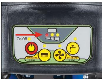
9. Branchez le chargeur de la batterie au moyen du cordon électrique fourni avec la machine pour le rechargement de la batterie. La charge est terminée lorsque le voyant DEL vert est allumé. (Voir Figures 28 et 29)
