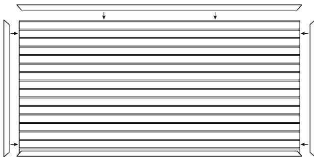
6. Deslice en su lugar las tres piezas con corte angular en J restantes. Ajuste hasta que las piezas de las esquinas encajen entre sí. Apriete todos los tornillos a la pared. (Vea Diagrama 6)
