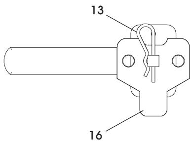
3. Avec la poignée toujours en position ouverte, accrochez les barres de verrouillage (15) à la came de verrouillage (16). Une fois en place, tournez doucement la poignée de porte en position fermée de sorte que les barres de verrouillage dépassent des trous en haut et en bas de la porte. (Voir Figure 11)
