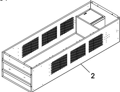
9. Alignez les rails de guidage du coffre bas (11) avec les quatre trous situés sur la partie inférieure des panneaux latéraux (2). Boulonnez-les aux panneaux (2). (Voir Figure 8)
