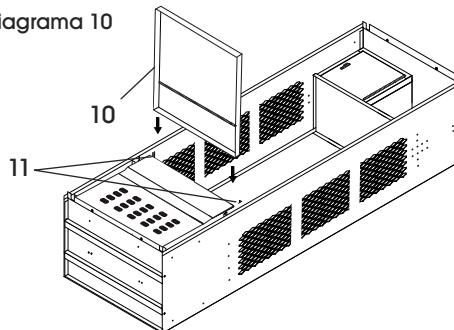
12. Una el panel rectangular más pequeño de la cubierta del cajón inferior (10) a los rieles del cajón inferior (11) en ambos lados. El pestillo del candado en la cubierta del cajón inferior (10) debe alinearse con el pestillo en el frente del cajón inferior (9). (Vea Diagrama 11)
