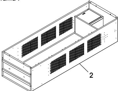
9. Alinee los rieles del cajón inferior (11) con cuatro orificios en la parte inferior de los laterales (2). Una a los laterales (2) con perno. (Vea Diagrama 8)
