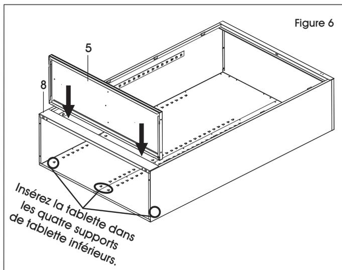
7. Avec l'aide d'une autre personne, placez l'unité à l'endroit, puis serrez tous les écrous et boulons. Installez les tablettes restantes. Assurez-vous que le bord de tablette sans fentes est orienté vers l'avant de l'armoire. Les fentes sur les trois autres côtés s'installent sur les supports de tablette sur les parois de l'armoire pour maintenir la tablette en place.
