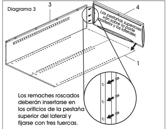
4. Fije el lado derecho (3) a la parte posterior como hizo en el Paso 2. Asegúrese de que la pestaña lateral se empalme con el panel posterior y de que la pestaña en la parte superior esté sobre el lado derecho. Empuje el panel lateral hacia arriba para que los remaches en la parte superior atraviesen los orificios de la arriba de la pestaña superior en el lateral. Apriete con 3 tuercas. (Vea Diagrama 4)
