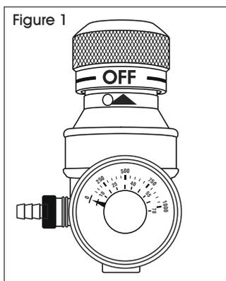
2. Vissez le régulateur de débit sur la bouteille de gaz d'étalonnage et assurez-vous que le joint est étanche.
