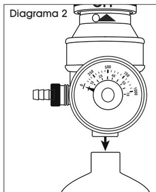
3. Conecte el tubo de plástico para prueba de tope a la salida del regulador de flujo deslizando el tubo sobre las ranuras de la salida.
