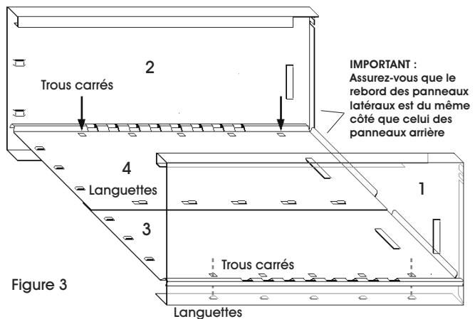
4. Enfoncez légèrement les languettes à l'aide du maillet en caoutchouc pour renforcer les raccords.
