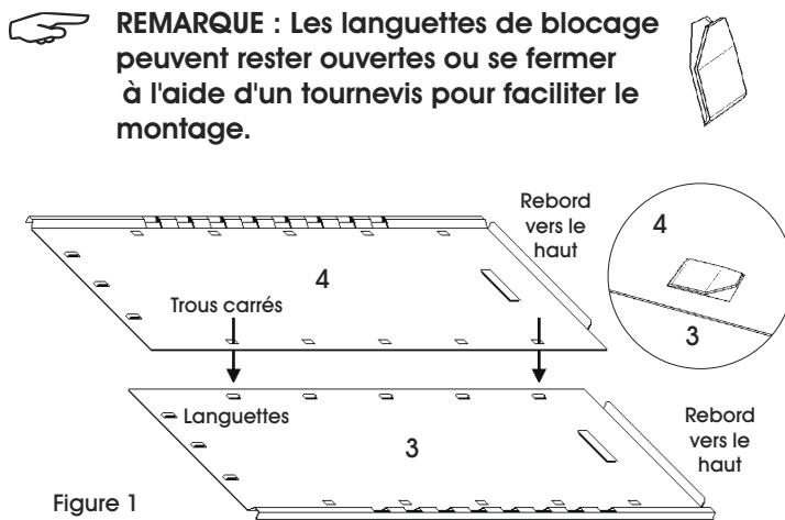
3. Lorsque les languettes de blocage sont insérées dans les trous carrés, faites glisser les panneaux arrière dans des directions opposées pour enclencher complètement les languettes. (Voir Figure 2)
