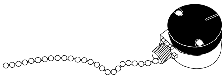
Interrupteur à chaîne et 3 accès électriques x 1
