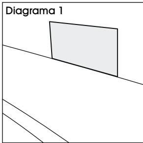
3. Coloque la placa con el patrón de cuadrícula a través de la superficie, incrustando, sin dejar marcas, la placa en el cemento utilizando un mazo de plástico.
