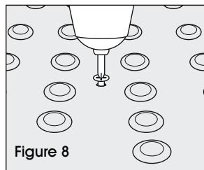
5. Installez la nouvelle dalle et exercez une légère pression sur celle-ci pour qu'elle s'insère solidement dans le renforcement. Insérez de nouveau les dispositifs de fixation inviolables dans les ancrages hexagonaux pour béton. (Voir Figure 8)
