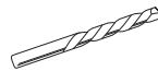
Broca de Taladro de 5/16" (solo para acero) Broca de Taladro de 3/16" (solo si no es acero)
