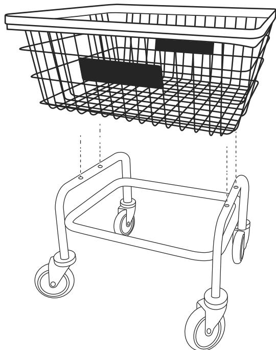
5. Coloque cuatro pernos a través de la parte superior interna de la canastilla de alambre y la base del armazón. (Vea Diagrama 3)
