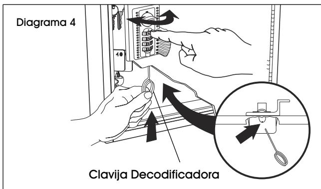
4. Cuando haya localizado el número correcto en el selector, la clavija decodificadora se deslizará hacia arriba para insertarse en una abertura en el selector. La clavija decodificadora estará completamente insertada en el cuerpo de la cerradura cuando se alcancen los números correctos en cada uno de los cuatro selectores. Estos cuatro números son la combinación de la cerradura. A continuación podrá tomar nota de la combinación y guardarla en un lugar seguro o cambiar la combinación.
