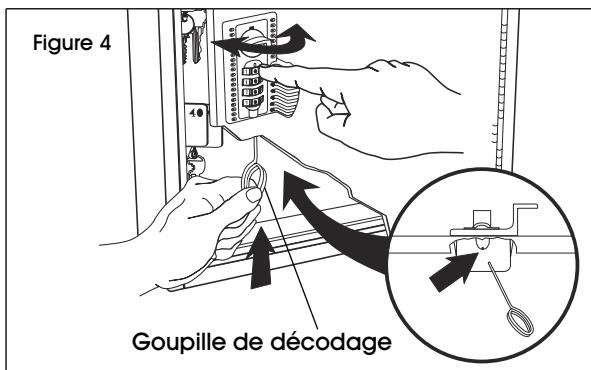
4. Lorsque vous avez trouvé le bon chiffre sur le cadran, la goupille de décodage glissera vers le haut dans une fente du cadran. La goupille de décodage sera complètement insérée dans le corps de la serrure lorsque les quatre cadrons sont définis sur les bons chiffres. Ces quatre chiffres constituent la combinaison de la serrure. Vous pouvez alors enregistrer la combinaison et la garder dans un endroit sûr, ou bien la modifier.
