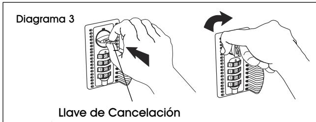
3. Para decodificar la cerradura, primero deberá abrirse la puerta del gabinete. Dentro de la puerta del gabinete, localice una abertura redonda pequeña en la parte inferior de la carcasa de la cerradura. Inserte la clavija decodificadora en la abertura y gire cada uno de los selectores por orden, comenzando por el selector inferior. (Vea Diagrama 4)
