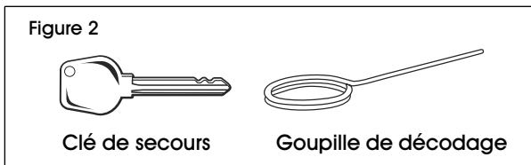
2. Pour utiliser la clé de secours, vous n'avez qu'à l'insérer dans la rainure et tourner le loquet; la porte de l'armoire s'ouvrira et la serrure peut alors être décodée. (Voir Figure 3)
