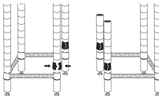
5. Glissez une tablette carrée sur les quatre montants intérieurs jusqu'à ce que la tablette repose fermement sur les supports. (Voir Figure 8)
