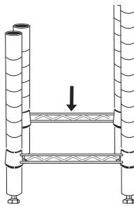
3. Tome los otros cuatro postes largos e inserte los soportes para repisas ejerciendo presión en la ranura inferior de los cuatro postes. Deslice los postes a través del lado inferior de la estructura cuadrada hasta que se deslice con firmeza sobre los soportes. (Vea Diagrama 6)
