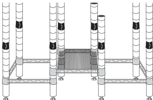
7. Deslice cuatro barras de soportes para canastilla en los postes hasta que las barras se deslicen con firmeza sobre los soportes. (Vea Diagrama 10)
