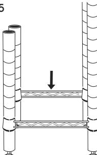
3. Prenez les quatre autres grands montants et encluez les supports de tablette à la rainure la plus basse des quatre montants. Insérez les montants par le dessous du cadre en carré jusqu'à ce que le cadre repose fermement sur les supports. (Voir Figure 6)
