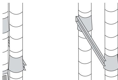
8. Inserte ocho juegos de soportes para repisas en los postes con cinco ranuras visibles en los ocho postes. Deslice cuatro barras de soportes para canastilla en los postes hasta que las barras se deslicen con firmeza sobre los soportes. (Vea Diagrama 11)
