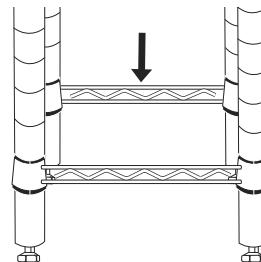
4. Coloque cada uno de los cuatro postes como se muestra e inserte cuatro juegos de soportes para repisas ejerciendo presión en la ranura ubicada justo encima de las estructuras cuadradas de los cuatro postes interiores. (Ver Diagrama 7)
