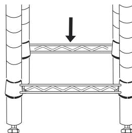
4. Placez chacun des quatre montants comme sur l'illustration et encluez quatre ensembles de supports de tablette dans la rainure immédiatement au-dessus des cadres carrés des quatre montants intérieurs. (Voir Figure 7)
