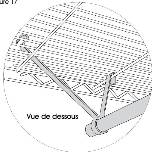
20. Tirez la tringle à vêtements vers l'arrière et vers le bas, un côté à la fois, jusqu'à ce que l'extrémité longue du support pour tringle à vêtements s'enclenche en position.
