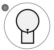
Le bouton TURNTABLE JOG (PLAQUE TOURNANTE MANUELLE) vous permet d'activer manuellement la plaque tournante. Lorsque vous appuyez sur ce bouton, le voyant dans le coin supérieur gauche du bouton s'allume. Appuyez sur le bouton START (DÉMARRER) pour activer la plaque. Si vous appuyez de nouveau sur le bouton, la plaque tournante s'arrête et le voyant s'éteint. Ce bouton peut être utilisé avec le bouton CARRIAGE JOG (CHARIOT MANUEL).
