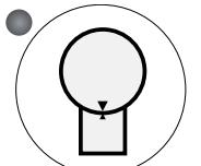
El botón TURNTABLE JOG le permite operar manualmente la plataforma giratoria. Cuando este botón es presionado, la luz en la parte izquierda superior del botón se enciende. Presione el botón START para poner a funcionar la plataforma. Al presionar de nuevo el botón detendrá la plataforma giratoria y la luz se apagará. Este botón puede utilizarse en conjunto con el botón de CARRIAGE JOG.
