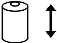
Tournez le bouton de réglage CARRIAGE SPEED (VITESSE DU CHARIOT) dans le sens horaire pour augmenter la vitesse du chariot et dans le sens antihoraire pour la diminuer. Cela vous permet de régler la superposition de votre film.
