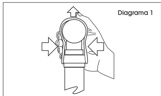
Esta acción levantará la boquilla de bloqueo y permitirá que la correa de seguridad se pliegue hacia abajo.
