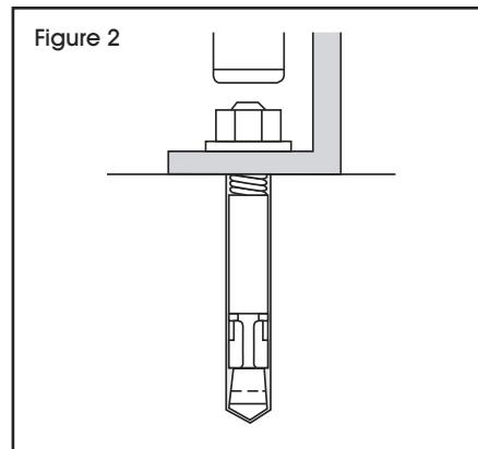
6. Serrez l'écrou en le tournant environ trois ou quatre tours complets.
